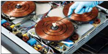
Aplique pasta termal conductora al sensor.
