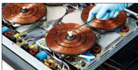
Tragen Sie die leitende Klebpaste auf den Sensor auf.
