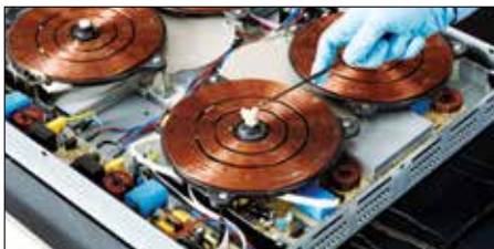
Applicare la pasta termale conduttiva sul sensore.
