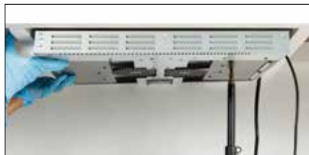
Fissare il sistema alla lastra di porcellana utilizzando un puntello mantenendo uno spazio da 5 cm a 10 cm su entrambi i lati per un corretto flusso d'aria.
